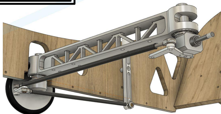
図2 アッカーマン機構
